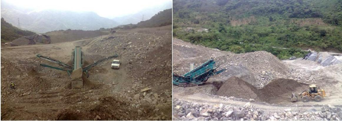
Figura 58 (izquierda) y figura 59 (derecha): Una máquina trituradora de grava utiliza el material rocoso extraído para su reutilización en el proyecto.
