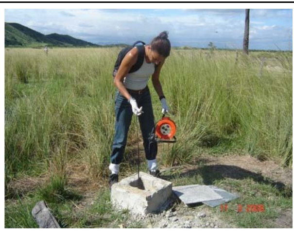
Figure 17: Groundwater collection. Sources: "Meio Físico" in Estudo de Impacto Ambiental: Central de Tratamento e Disposição Final de Resíduos Santa Rosa (Seropédica, RJ: 2007),75.
